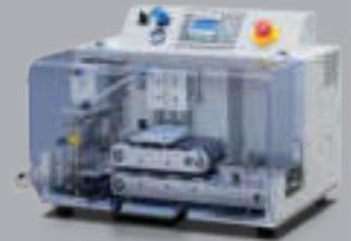
Fustellatura e taglio di cavi piatti, unipolari, multipolari, tubi e guaine
