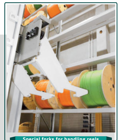
Special forks for handling reels Speciali forche per la movimentazione delle bobine
